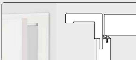
Bei der stumpfen Ausführung bildet das Türblatt eine annähernd bündige Ebene mit der Bekleidung.
